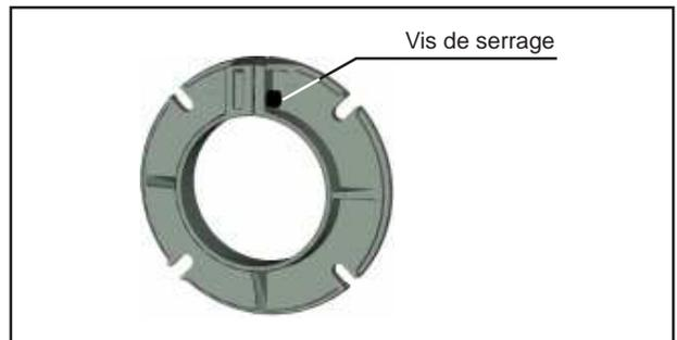
Dévisser la vis de serrage, visser cette même vis dans le taraudage repère opposé, la bride s'écarte et permet un démontage aisé du brûleur. Pour permettre ces manoeuvres, les écrous de fixation de la bride sur la chaudière doivent être légèrement desserrés.
