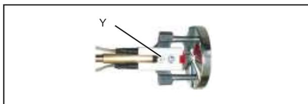
Débloquer la vis repère Y clé Torx N° 20, ôter l'ensemble électrodes-stabilisateur. Nettoyer cet ensemble sans démonter le bloc d'électrodes. Dévisser le gicleur à l'aide de 2 clés plates de 16, le changer. Revisser le gicleur sur la ligne, remonter l'ensemble électrodes/stabilisateur en respectant la position des électrodes. La mise en butée de l'ensemble stabilisateur sur la ligne fioul positionne l'extrémité du gicleur par rapport à l'arrière du stabilisateur (voir réglage page 9).
