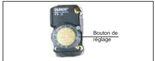
Le manostat d'air est réglé au mini en usine. Le contact (COM-NO) s'établit lorsque le ventilateur tourne (pression d'air normale). Le défaut d'enclenchement du manostat provoque la mise en sécurité du brûleur. Un bouton moleté, gradué en mbar, permet l'ajustement de la coupure. Ce réglage doit être effectué sur chantier pour obtenir le déclenchement et/ou la mise en sécurité du brûleur avant que le CO n'atteigne la limite autorisée de 1%.
